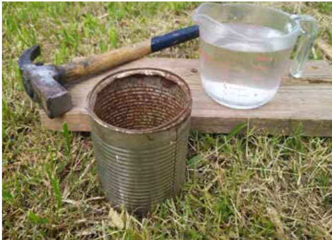
Figure 2. Elements for the infiltration test. Photo: Marc Gràcia.
